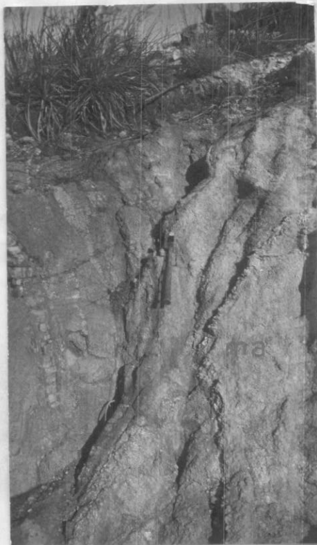
Foto N° 2.-Extremo norte de la cantera 1, frente E. Contacto entre el gneis y el material caolínico; g-gneis, m.a.-material caolínico, p-filoncito de pegmatita granodiorita, t-tierra vegetal.
