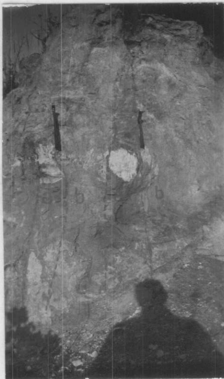
Foto nº 3. Canteral 1, frente E, algunos metros al S del lugar de foto 2. Diques de caolín blanco (a) dentro del material caolínico común (b).
