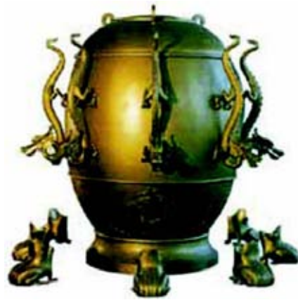
Figura 36. Instrumento chino para detectar terremotos, antecesor del sismógrafo.
