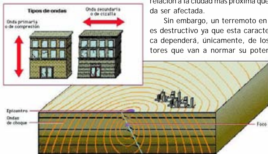
Figura 34. Tipos de ondas y efectos sobre las construcciones.
