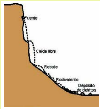
Figura 12. CAÍDAS: Movimientos en los cuales uno o varios bloques de suelo o roca se desprenden de una superficie de una ladera. Una vez desprendido, el material se desplaza en caída libre, pero con algunos golpes, rebotes y rodamiento.
