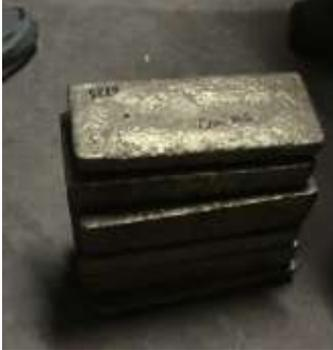
Toda la operación de perforación y obtención de las muestras de todos los lingotes se realizó dentro de una fuente de acero inoxidable, por lo que finalmente se obtuvo una sola muestra de aproximadamente 80 gramos en forma de virutas; luego se procedió a conformar una pila y dividirla en 4 partes (cuarteo); una de ellas se colocó en una bolsa de muestreo y se la mezcló durante 10 segundos (roleo); luego se la dividió en cuatro partes iguales en forma manual, usando la balanza para la división,
