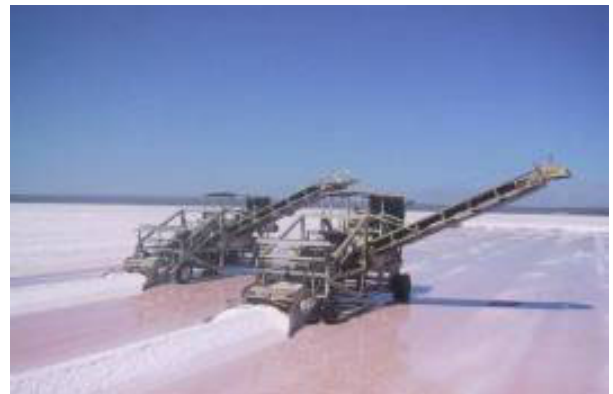
Fotografía 5: Corte de la capa de sal y formación de cordones
