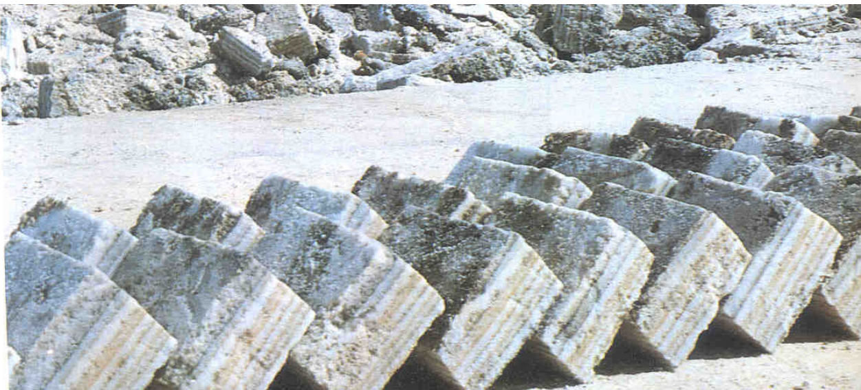
Fotografía 4: Explotación de sal por sistema de panes. Se puede observar los diferentes colores en los panes debido a la presencia de impurezas
