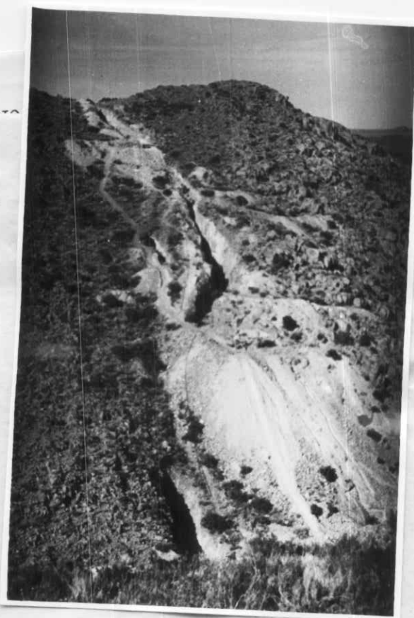
Nº9. Aspecto parcial de labores superficiales (rajes y trincheras), que ponen de manifiesto la inclinación de las vetas.
