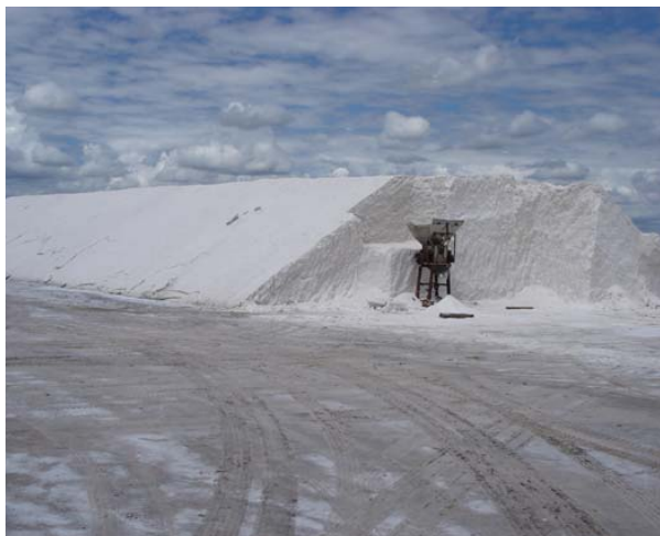
Figura 11: Acopio de sal en la costa de la salina. El material se compacta en la pila, por lo que se usa una trituradora para su envasado.
