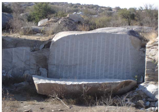
Figura 24: Frente de explotación realizado mediante precorte con barrenos y separación con voladura en cantera del Grupo La Playa.
