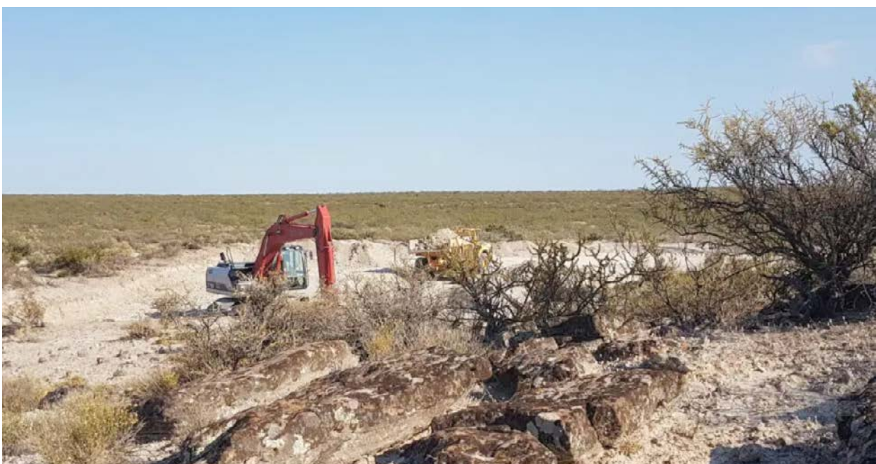
Figura 17. Extracción de arenas silíceas en Bajo Santa Rosa. En primer plano se observan troncos petrificados.
