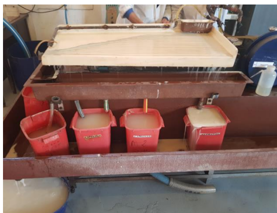
Figura 1. Proceso de concentración en Mesa Wilfley
