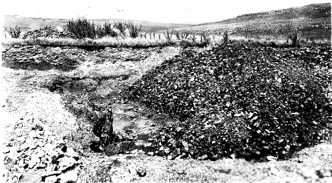
Foto N°4 - Destape - Se observa la brecha de fricción originada por el corrimiento.
