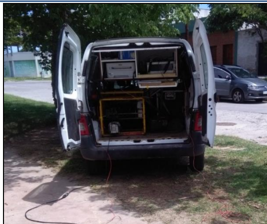
Fotografía 3.5: Perfilador geoelectrónico utilizado en la perforación de estudio.
