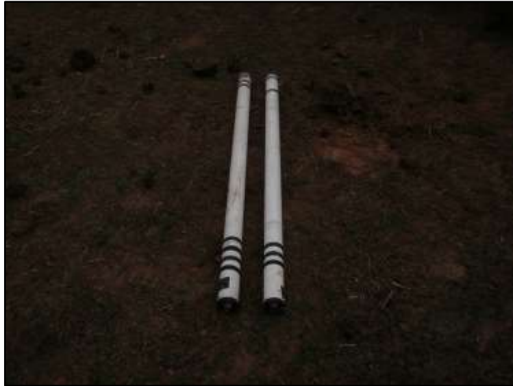
Foto 4: Imagen de la barras de lectura del campo magnético de bajas frecuencias. La barra izquierda está señalizada para ubicarse en sentido E-W y la barra de la derecha para una ubicación en sentido N-S.
