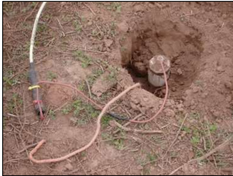
Foto 3: Imagen de un electrodo impolarizable correspondiente al arreglo de registros para bajas frecuencias MT.
