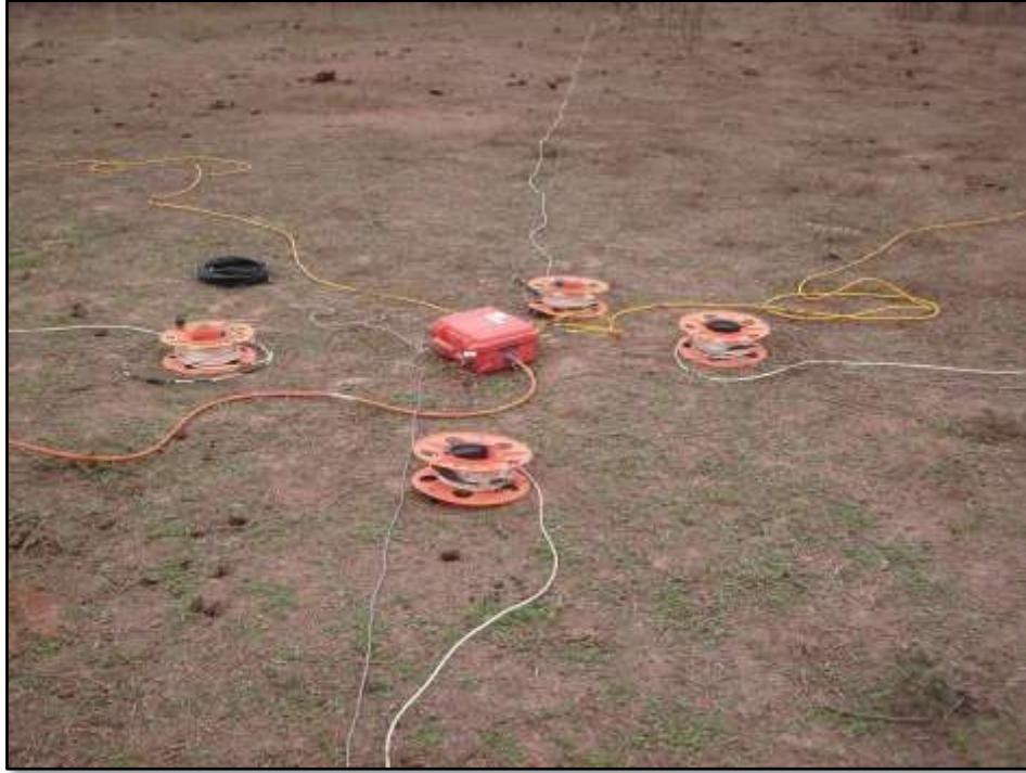
Foto 2: Nodo de conexión de los 2 sensores magnéticos (barras Hx y Hy) con orientación N-S y E-W, y los 4 dipolos (Ex e Ey) con orientación N-S y E-W.
