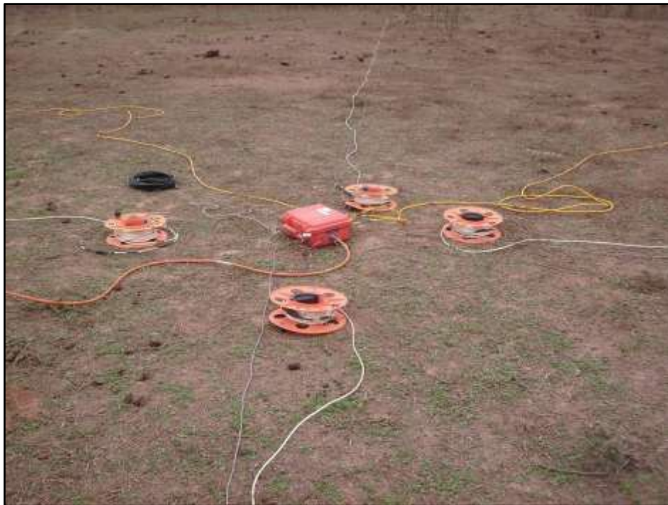
Foto 2: Nudo de conexión de los 2 sensores magnéticos (barras Hx y Hy) con orientación N-S y E-W, y los 4 dipolos (Ex e Ey) con orientación N-S y E-W.
