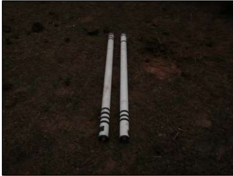
Foto 4: Imagen de las barras de lectura del campo magnético de bajas frecuencias. La barra izquierda está señalizada para ubicarse en sentido E-W y la barra de la derecha para una ubicación en sentido N-S.
