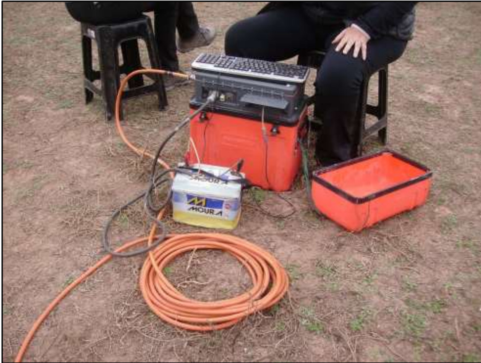
Foto 1: Logger de medición Stratagem con una batería de alimentación de 12 volts.
