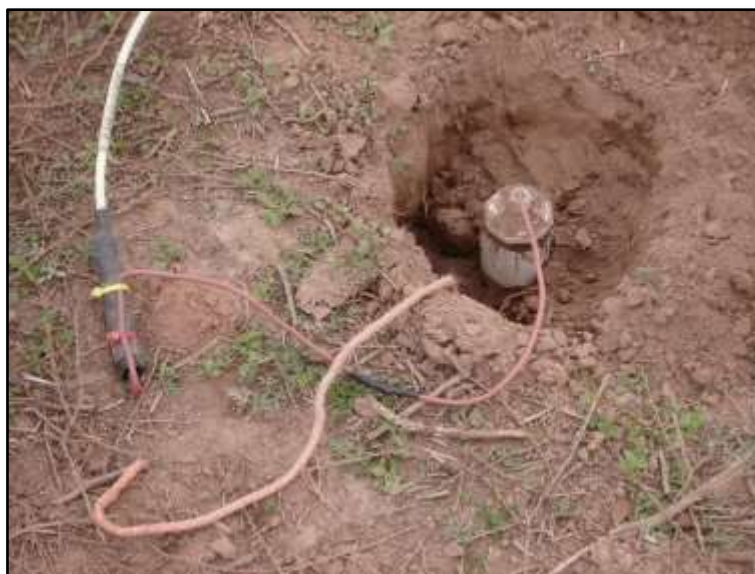
Foto 3: Imagen de un electrodo impolarizable correspondiente al arreglo de registros para bajas frecuencias MT.
