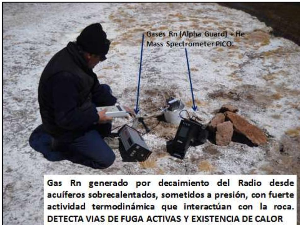
Foto 1: se ilustran los espectrómetros que se emplearán en este proyecto.
