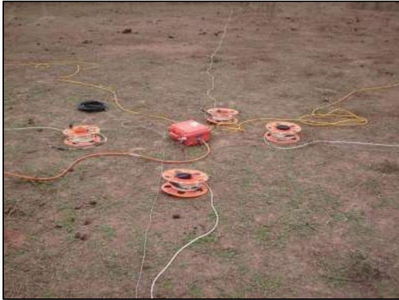
Foto 3: Nudo de conexión de los 2 sensores magnéticos (barras Hx y Hy) con orientación N-S y E-W, y los 4 dipolos (Ex e Ey) con orientación N-S y E-W.
