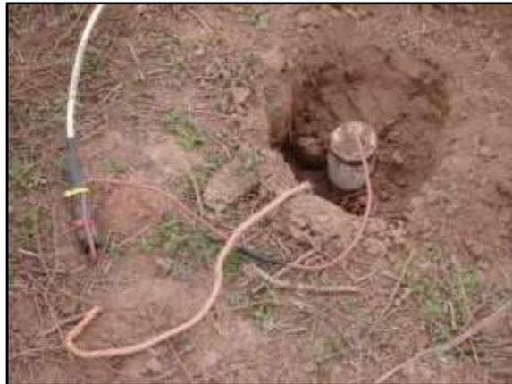
Foto 4: Imagen de un electrodo impolarizable correspondiente al arreglo de registros para bajas frecuencias MT.
