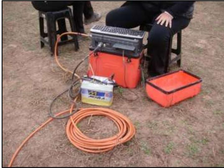
Foto 2: Logger de medición Geometrics model Stratagem con batería de alimentación de 12 volts.
